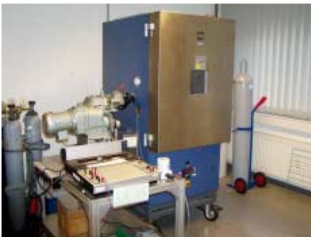
Bild 1: Prüfung auf Temperaturbeständigkeit in eine Temperaturschrank
