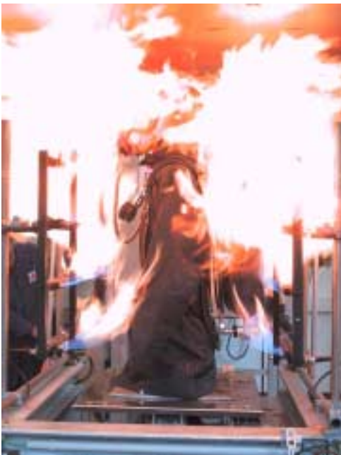
Bild 6: Prüfung der Beflammung nach prEN 137:2002
