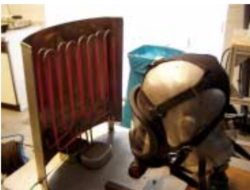
Bild 2: Prüfung einer Vollmaske auf Beständigkeit gegen Wärmestrahlung
