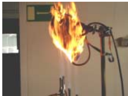
Bild 4: Prüfung eines Lungenautomaten auf Entflammung
