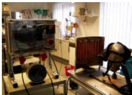
Bild 3: Prüfung eines Lungenautomaten auf Beständigkeit gegen Wärmestrahlung
